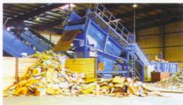
Tolva con piso móvil y dosificador Clasificación papel / cartón por criba de discos
